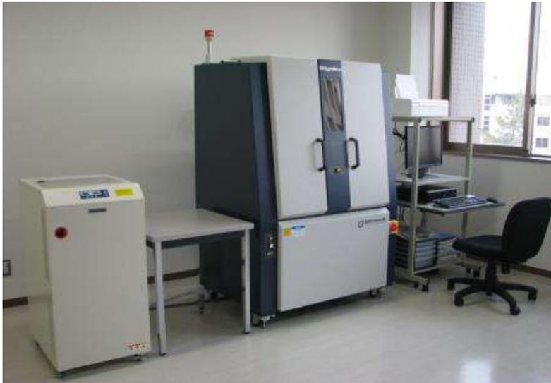
高温下における大気中 (空気中) ・真空中 ・不活性ガス中でのIn-Situ測定可能な試料水平型多目的粉末X線回折装置。
