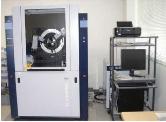
大気雰囲気下、物質を非破壊で分析することができます。定性分析、格子間隔の測定や応力測定、またピーク面積の計算などから定量分析を行うこともできます。
