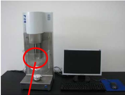
「回転トルク」と「垂直荷重」の同時による高感度で再現性の高い粉体流動性分析装置。
