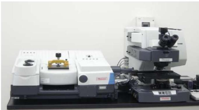
フーリエ変換赤外分光法による物質の化学組成の同定および分子構造の解析、光学顕微鏡との組み合わせによる微小試料の測定およびマッピング。
