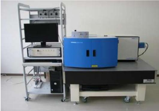
ラマン散乱光の分光による物質の化学組成の同定や分子構造の解析、レーザ・共焦点光学系と組み合わせた3次元マッピング。
