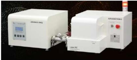
スキャニングレーザ加熱AC法により、フィルム、薄板、薄膜などの薄板材料の面内方向熱拡散率測定装置です。
