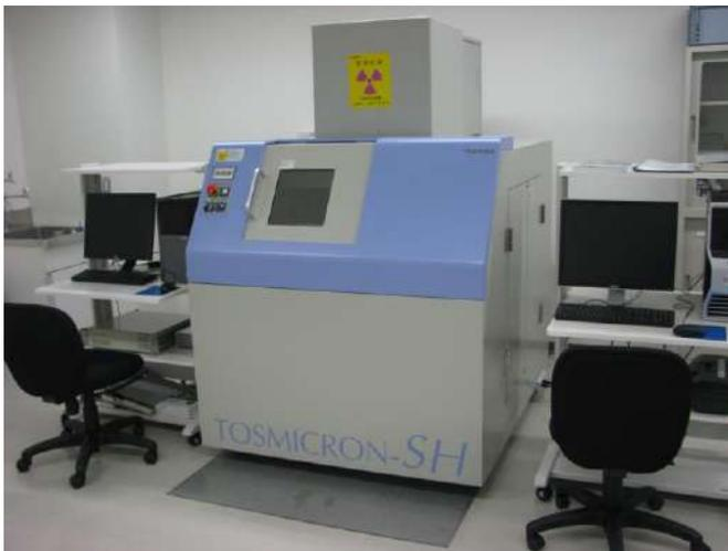
焦点径1μmに絞ったX線を照射し、幾何学倍率最大1200倍でイメージング。
